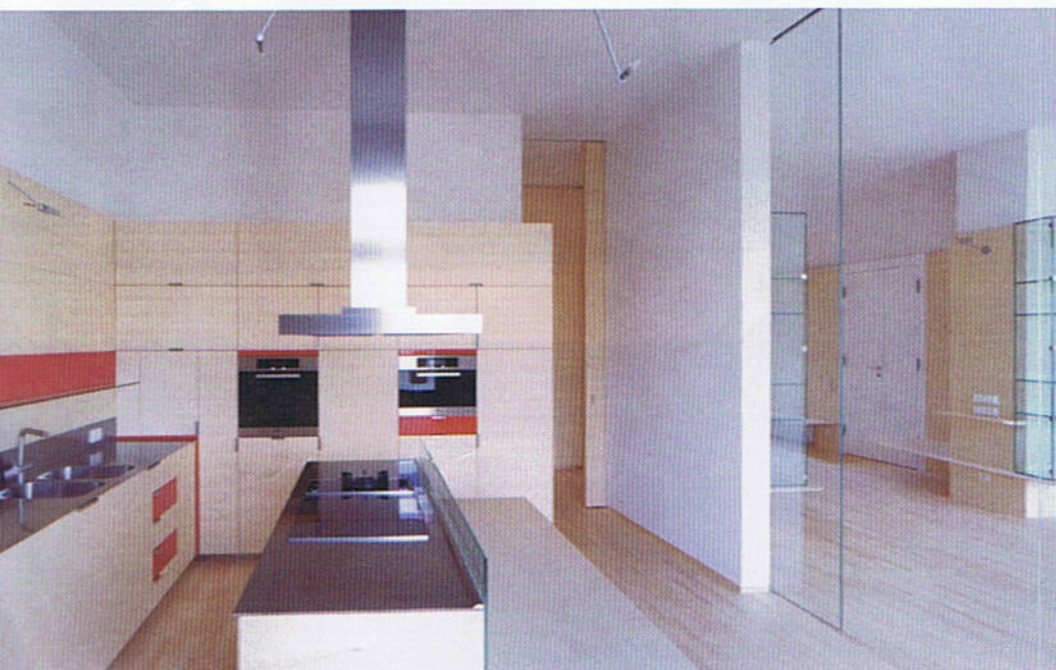
Die Wegnahme von Zwischenwänden sichert die notwendige Transparenz. Glasschiebe-Elemente ermöglichen das Abtrennen von Bereichen.
